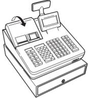
2. Öffnen Sie den Batteriefachdeckel hinter der Papierrollenaufnahme.
