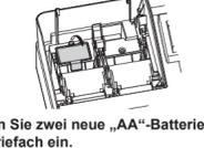
4. Setzen Sie zwei neue „AA“-Batterien in das Batteriefach ein.
