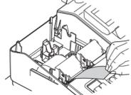
7. Heben Sie den Thermodruckwalzenarm auf der Journalstreifenseite an.
